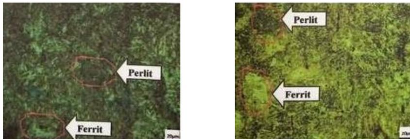
**Gambar 4.1** Struktur Mikro Raw Material
