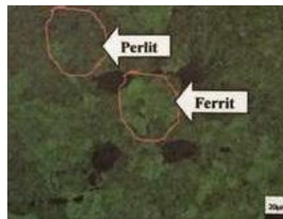
**Gambar 4.3** Struktur Mikro Sampel A4
