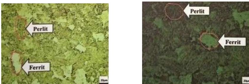
**Gambar 4.2** Struktur Mikro Sampel A3
