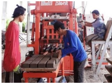
Gambar 1. 2 Proses Pembuatan Paving Blok
