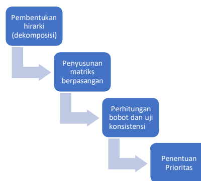
Gambar 3 Tahapan Dalam Metode Analisis Hirarki Proses
