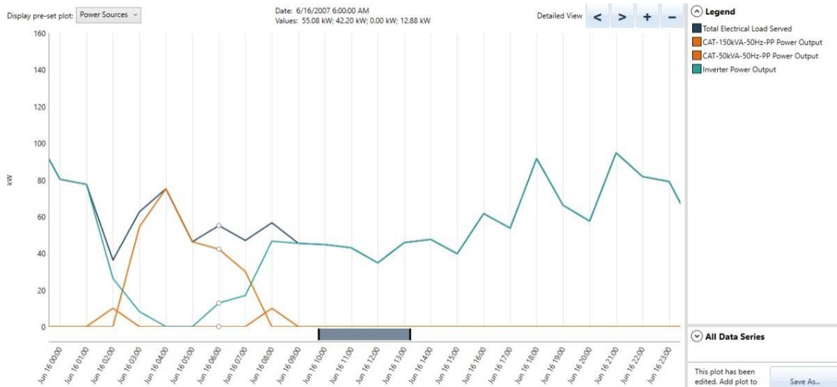
Gambar 3. Diagram penetrasi masing-masing pembangkit terhadap beban sistem isolated Sebotok
