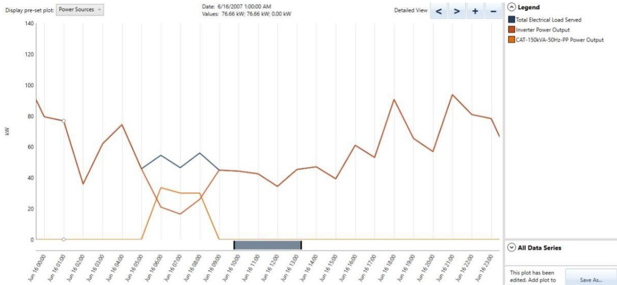
Gambar 4. Diagram penetrasian masing-masing pembangkit terhadap beban sistem isolated Labuan Aji
